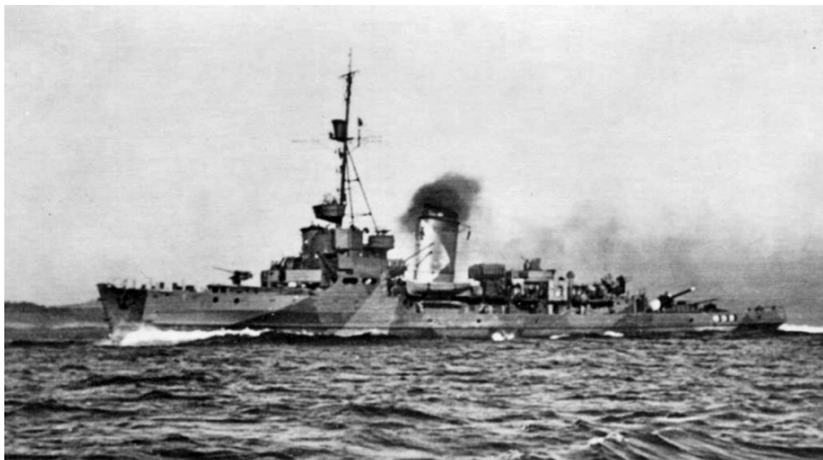
Den tyske minestryger »M 305«. Den var af samme type, Minensuchboot 40 , som M 426 og M 470 , der massakrerede de svenske fiskere i Skagerrak den 25. august 1943. Skibene var på 775 tons, kunne sejle op til 17 knob og var bevæbnet med en 10,5 cm kanon, en 3,7 cm og syv 2 cm luftværnskanoner. (Wolfgang Müllers samling)
