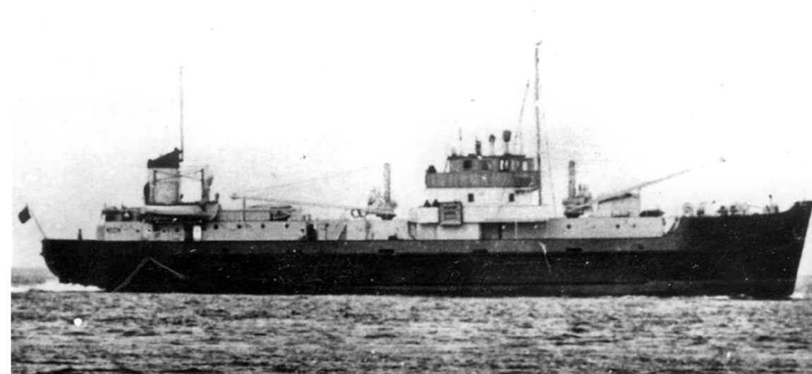
Minetransportskibet »Irben«, som i en periode lå i Thyborøn for at kunne udlægge i gennemsejlingsåbningen i minespærringen ved Hanstholm. Skibet var på 900 bruttoregistertons og bygget i 1936 specielt til opgaven med at transportere miner. Med kun fire 2 cm luftværnskanoner var skibet ganske svagt bevæbnet. (Samling Baasch via Flemming Hansen)
