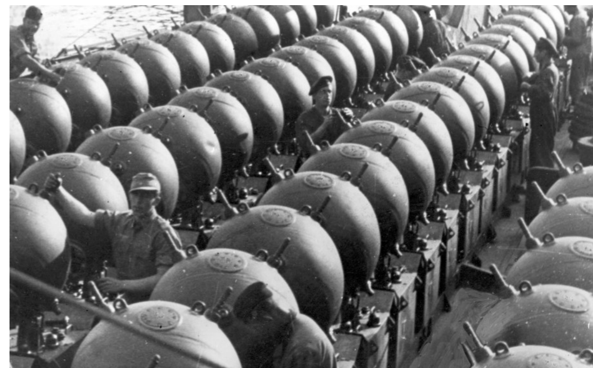
Agterdækket på en tysk minelægger fyldt op med rækker af ankerminer af typen EMD. Soldaterne er i gang med at skrue minehorn i, så minerne bliver klar til udlægningen. (Søværnets våben- og taktikskole).
