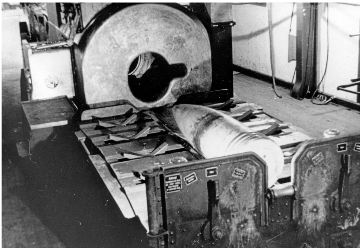
En 38 cm-granat ligger på ladevognen bag kanonen – klar til at blive skubbet ind i kammeret. (Bunkermuseum Hanstholm)
