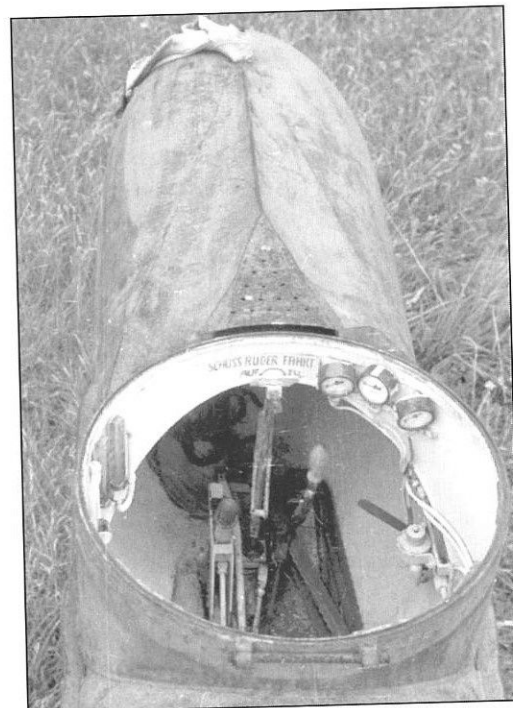
Figur 7. Kig ned i cockpittet på en "Marder" fra K-Flotille 361. Man får her indtryk af de trange pladsforhold, og de primitive instrumenter. Gerå, 20. august 1945. (F.G. Tillisch/Museumscenter Hanstholm)
